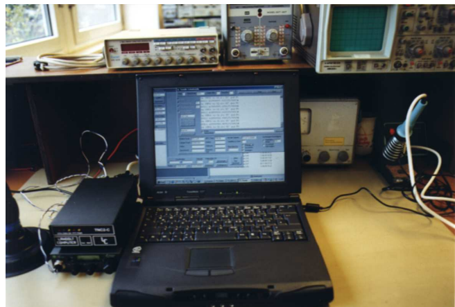
Die Empfangsseite - Experimentell: TNC, CB-Funkgerät und Antenne neben unserem „Stationscomputer“
